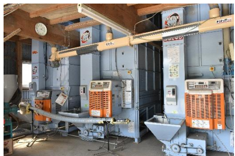
自宅倉庫内の乾燥調整機
